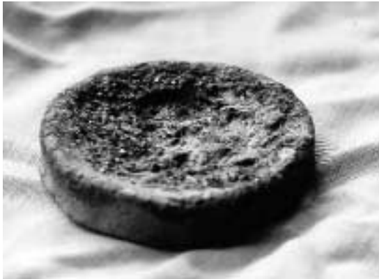
Fig. 7. Käril 4 efter utfört experiment. Bly/silver-smältan var vid experimentets början nästan lika stor som i fig. 8, men då stora delar av det ingående blyet oxiderat återstod vid försökets avslutande en smälta av den storlek som antyds av den lilla fördjupningen i kärlets yta. Depressionen har en skrovlig och porig gulgrön förglasning i botten, färgerna i kärlets yta pendlar mellan rött, gulgrönt och blågrönt. Foto författaren.
