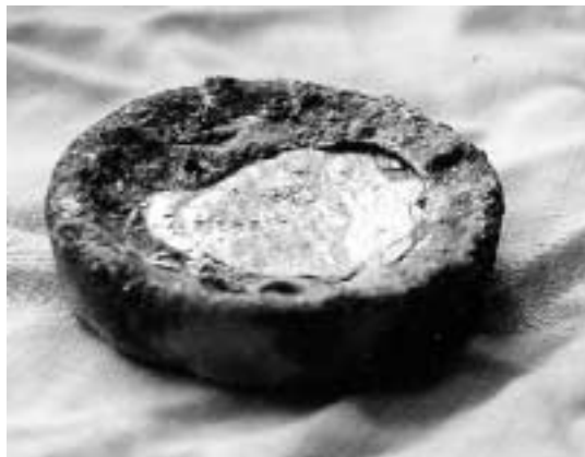
Fig. 8. Käril 1 efter utfört experiment. Bly/silver-smältan har fått stelna i kärlet på ett tidigt stadium i processen, för att demonstrera smältans läge i den djupt nederoderade depressionen. Foto författaren.
